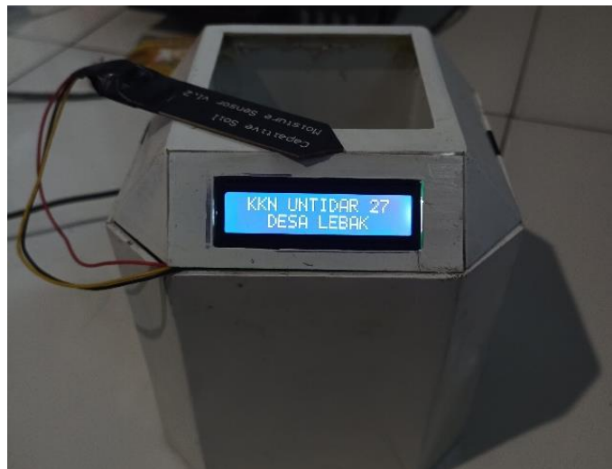
Gambar 2. Alat monitoring kelembapan tanah dan penyiraman otomatis berbasis ESP32
