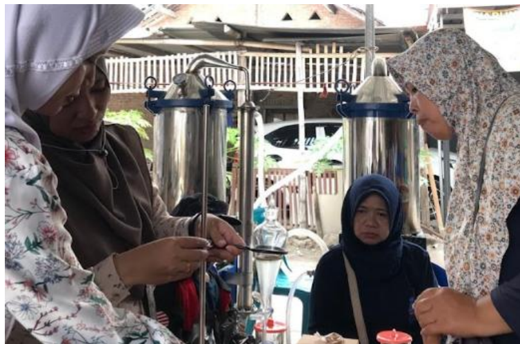
Gambar 3. Proses pemurnian minyak sereh menggunakan corong pisah
