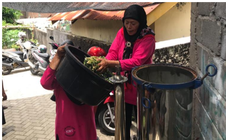
Gambar 2. Proses destilasi minyak atsiri sereh oleh anggota KWT
