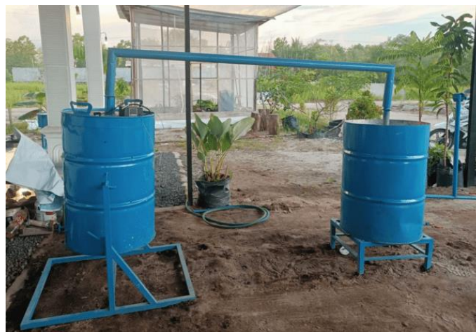
Gambar 4 . Desain reaktor pirolisis
