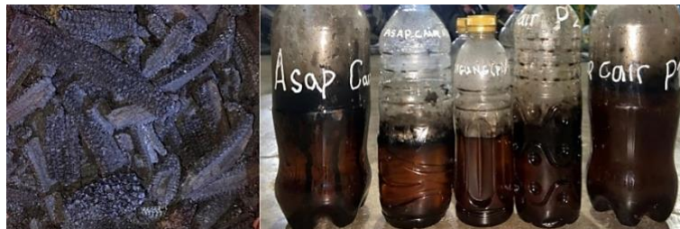
Gambar 4. Hasil pirolisis limbah jagung: arang (kiri) dan asap cair (kanan)
